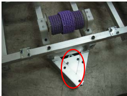
圖四：利用不旋轉之輔助輪以保持蝙蝠車之直線度
