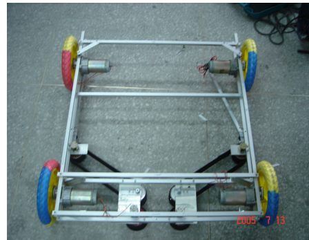
圖一：底盤完成之情況
