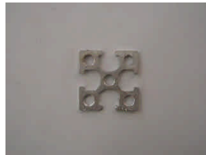
圖五：2cm*2cm 的鋁擠切面圖
