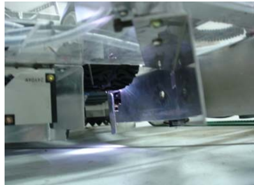
圖十二、辨球機制實際裝在機器人之情形
