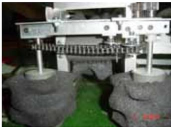
圖十七 以鏈輪、鏈條、正齒輪的出球機構
