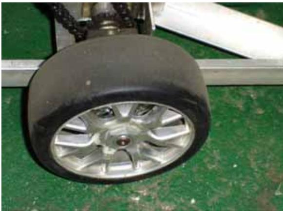
(圖三) 主動輪選用遙控賽車用的輪胎
