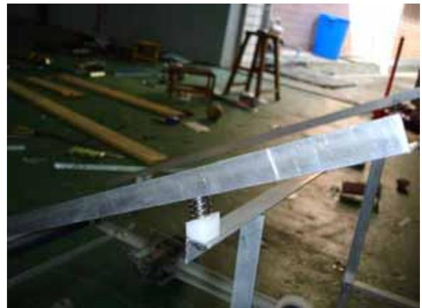
(圖五) 用 L 形的角鋁所架出來的斜桿
