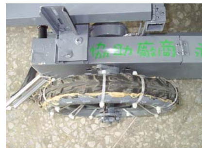
圖九：採用較好輪皮增加抓地力
