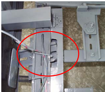
圖四：利用推擠原理使開
