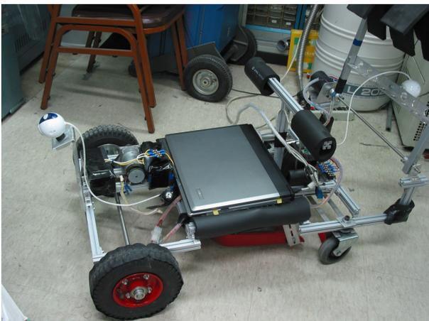
圖 11 取球手臂抬起時的機器人
