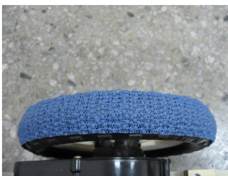
圖 6. 輪子上包覆止滑墊增加抓地力
