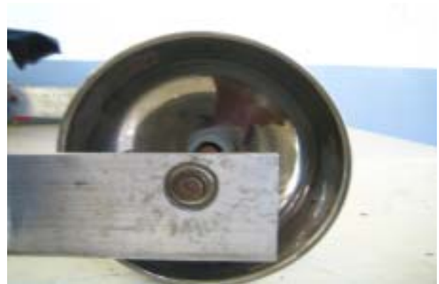
圖五 RODJ 使用之滾珠軸承
