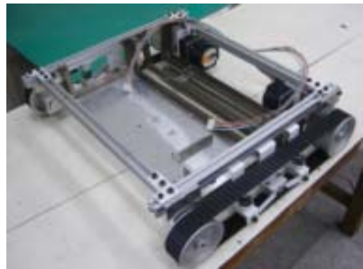
圖 1 履帶式底盤結構的實體照片
