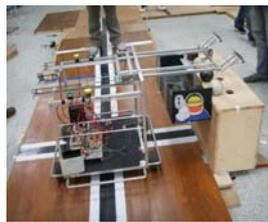
2. **方向感測**：機器人行走時會讀取車體中間三顆感測器的感測值，依據感測值來修正車子的方向。
