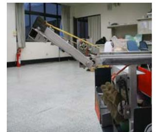
(2) 延伸機構: 利用本組字型設計之滑軌搭配口字型鋁構成一可前後延伸之機構, 再搭配時規鋁輪及時規皮帶作為伸縮以及回縮動作之媒介, 控制方面是由單晶片控制直流馬達驅動。
