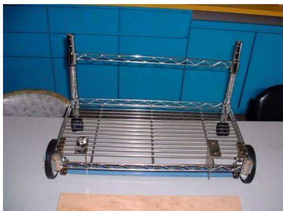
圖二：機器人的主體——鍍鉻網架。
