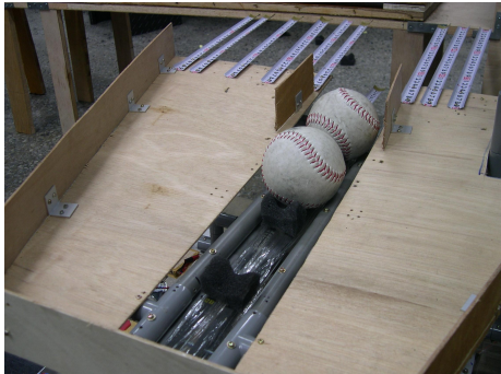
圖 1.1-7 置球機構(輸送帶)
