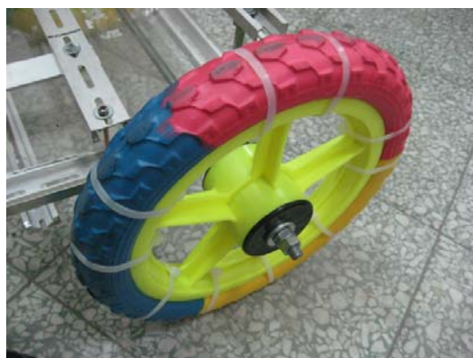
圖 1：束線帶將輪框與泡棉胎固定
