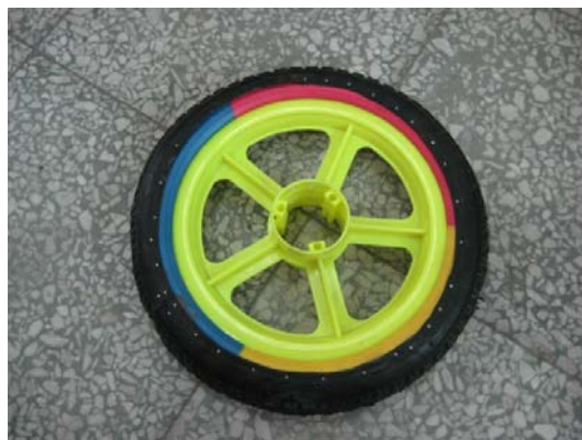
圖 2：腳踏車橡皮外胎以強力膠與大頭針固定
