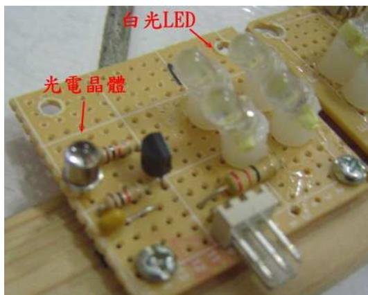
圖 15 光感測器實體電路
