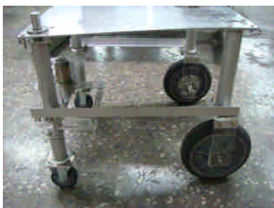
(圖 13)底部側邊固定補強
