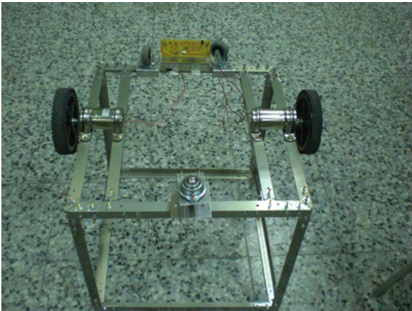
圖(三)車輪&前後輪軸
