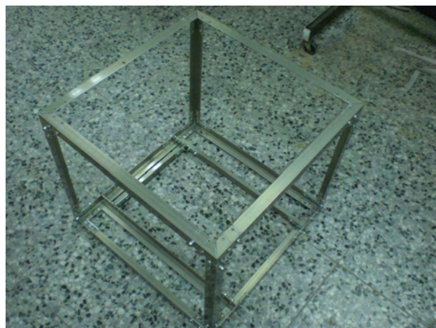
圖(二)車體主結構
