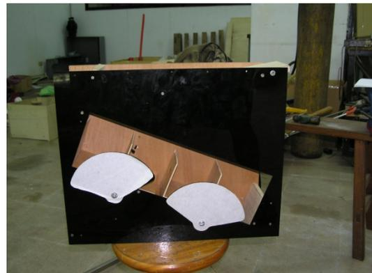
圖一為儲存球箱，當球落下時，將分別落入四個球道裡面。接著，根據路徑需要，由程式控制驅動版讓，控制球門板的馬達正反轉達到開門的目的，。
