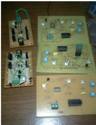
圖為我們驅動電路還有顏色判斷線路的製作，然而為了使顏色輸出訊號得以穩定，因此我們選擇把電路 layout 出來，避免洞洞板搭棚有一些阻抗的問題，圖二就是我們手工洗版子時候曝光的圖示。
