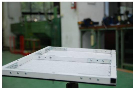
底盤為鋁合金及壓克力，驅動使用履帶輪，經過 4 次的改版，在震動和履帶脫落的問題取得平衡，以及馬達的相對位置配合，最後才決定其為該形狀，確認其相對孔位。
