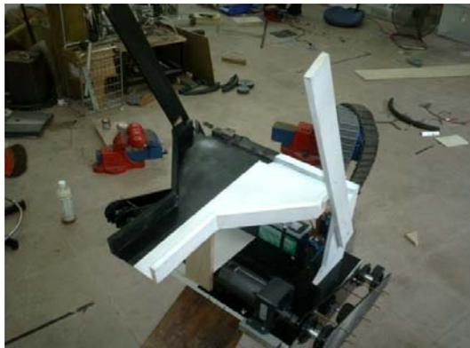
圖二：為一球道，球門打開後球可順此球道，自然滑落，球道出口距離地面 31cm。
