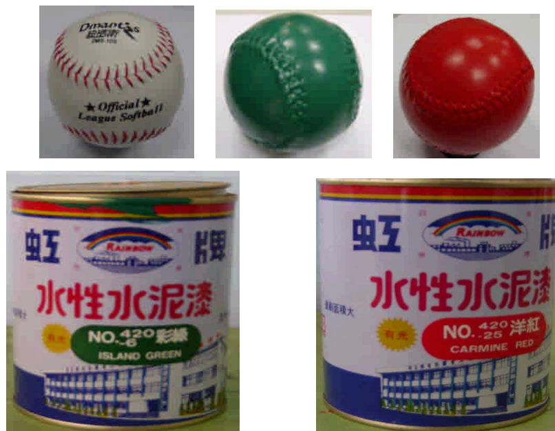
圖五 球尺寸 ( \phi 9.5\pm 0.3\text{cm} , 280\pm 10\text{g} ) 與水泥漆規格
